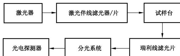
图 1 色散型激光拉曼光谱仪组成框图
